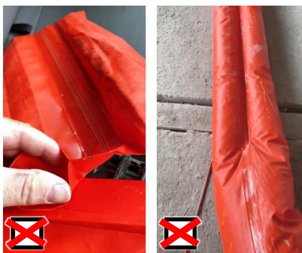
Fig. 1-2: verklebter Kalibrierschlauch
