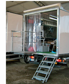
Markise und Absturz-Sicherung...
