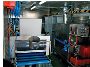
Ausbau mit Dampf-Erzeuger ST-150 und Kalibrierwalzen-Bank KWBO-300...
