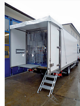
Aufstiegs-Treppe, Regenplane, Kältevorhang und fixierte Türflügel (Halterung)...
