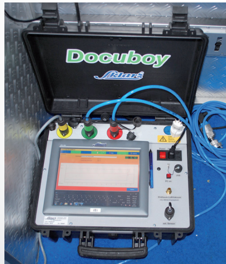
Sanierungs-Dokumentation und Druckprüfung...
