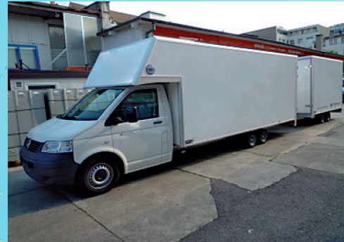
Hausanschluss-Lineranlage für städtischen Betrieb. Ein FIAT Ducato (Bild VW T5) kann als 3,5 oder 4,2 Tonnen Fahrzeug zugelassen werden...
