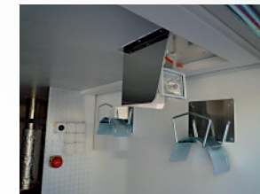
Heckleuchte mit separatem Schalter und NOT-AUS...
