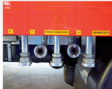
Externe Anschlüsse für die Wasser-Vorsorgung...
